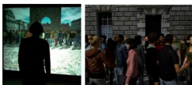
Dispositif de RV dans le studio 4 de l'Ircam. La stéréo visuelle est projetée sur un grand écran. La mise à jour des informations visuelles et auditives est réalisée grâce à un système de suivi de position.
