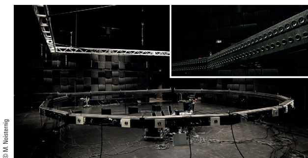
Dispositif de restitution sonore WFS – HOA du Curtis R. Priem Experimental Media and Performing Arts Center au Rensselaer Polytechnic Institute de Troy (US). Le dispositif est constitué de 16 antennes linéaires de haut-parleurs espacés de 5,8 cm, ici configurées pour une diffusion HOA bidimensionnelle.
