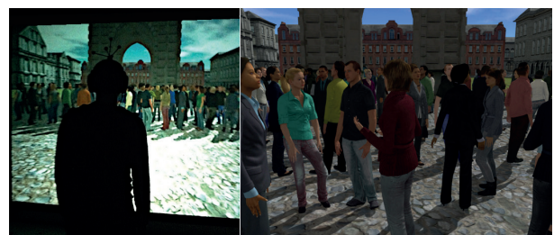
Dispositif de RV dans le studio 4 de l'Ircam. La stéréo visuelle est projetée sur un grand écran. La mise à jour des informations visuelles et auditives est réalisée grâce à un système de suivi de position
